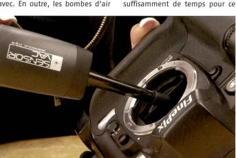
L'aspirateur est une alternative à l'air comprimé, «Visible Dust» et «Delkin» proposent des modèles appropriés. On peut également venir à bout de la poussière tenace avec une bombe d'air comprimé. Mais attention: outre de l'air, il est possible que la bombe laisse parfois aussi échapper du liquide.
