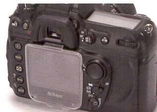
Bascule multifonctions confortable à droite de l'écran pour la mise au point de l'autofocus.
