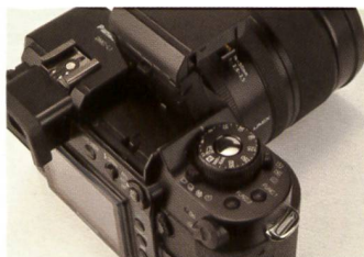
Molette de réglage grand luxe pour le réglage du temps d'obturation sur le Panasonic Lumix L1.
