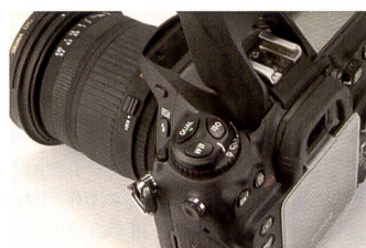
La molette intègre des boutons supplémentaires pour la balance des blancs et la sensibilité ISO.
