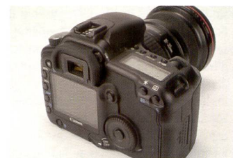
Extrêmement pratique: la molette de sélection rapide à droite de l'écran ACL 2,5 pouces.
