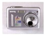
Le zoom optique 3x de l'E605 sort et se rétracte du boîtier par rotation. Une solution astucieuse qui limite l'encombrement.
