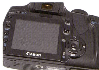
Faute de place, l'EOS 400D n'a pas de molette de réglage, mais des touches disposées en cercle.
