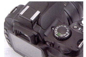
La molette arrière met au point le diaphragme ou le temps d'obturation selon le mode d'exposition.
