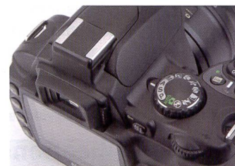
La molette arrière met au point le diaphragme ou le temps d'obturation selon le mode d'exposition.
