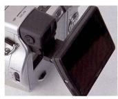
Le Sony Cybershot DSC-H9 est doté d'un écran à cristaux liquides orientable pour réaliser des photos dans les perspectives les plus insolites.
