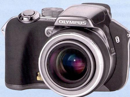
L'Olympus SP-550UZ est le premier appareil au monde doté d'un zoom 18x. Il dispose d'une plage focale exceptionnelle (28-504 mm en équivalence 35 mm) pour répondre à tous les besoins des photographes. Il est également doté d'un double système de stabilisation d'images pour garantir des prises de vue nettes même en cas de tremblement de l'appareil ou lorsque les sujets sont en mouvement.
