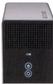
Le nouveau DataTank de Freecom contient jusqu'à un tera-octet sur son système à double disque dur S-ATA fonctionne au choix en mode RAID et/ou JBOD. L'appareil est livré avec la version intégrale du logiciel de sauvegarde et de restauration (back-up) Acronis True Image qui permet de restaurer l'ensemble des fichiers, y compris le système d'exploitation ainsi que la totalité des applications. Ce matériel est vendu au prix de 969 francs (1 To), 779 francs (800 Go) et 589 francs (500 Go)
