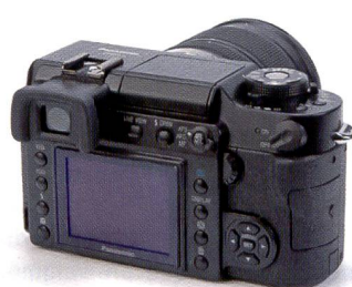
Le système Live View autorise un contrôle plus simple de la composition des images qu'à travers le viseur et des angles inhabituels.
