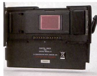
Tout est dans le dos: le capteur se situe exactement à l'emplacement du plan focal.
