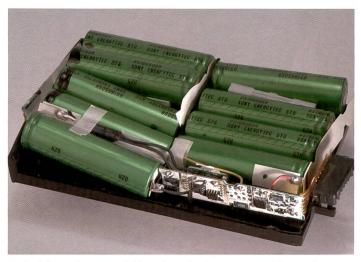
Vie intérieure d'un accu lithium-ions d'ordinateur portable: plusieurs cellules sont branchées en batterie. Le nouvelle technologie lithiumpolymère offre une flexibilité de forme qui débouche sur des éléments le plus souvent plats.
