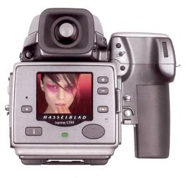
un système d'exploitation muns. Combiné aux dos numériques de la série Ixpress déjà commercialisés, le modèle H2 offre exactement les mêmes fonctionnalités que son frère aîné le H1. H2 comme H2D sont équipés d'un capteur CCD 22 mégapixels 37 x 49 mm. La sauvegarde intervient au choix sur cartes portables CF, disque dur mobile FireWire et transfert filaire vers MAC ou PC
