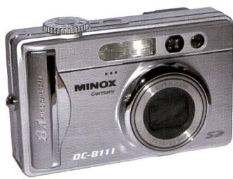
pour les éléments de commande. L'appareil donne une impression de maniabilité et de convivialité. Malgré sa petite taille, il reste encore de la place pour un viseur optique. L'objectif est un modèle Minotar f2,8 à 4,8 / 7,2 à 22,5 mm (32 à 96 mm Ko) avec autofocus. Les données sont enregistrées sur des cartes SD de 64 Mo à 1 Go.
