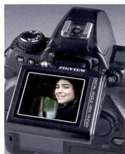
En raison de leur forme de construction, les boîtiers reflex numériques n'affichent pas une image en prise directe. Zigview remédie à cette carence en lançant un viseur numérique à écran LCD qui se monte simplement sur l'oculaire du viseur des reflex numériques et argentiques.
