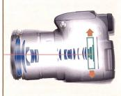
Les systèmes (le plus souvent débrayables) qui équipent les objectifs reflex visent à compenser les mouvements du boîtier pendant la prise de vue (flou de bougé). La stabilisation d'image fait appel à des groupes de lentilles mobiles (p. ex. flottant dans l'huile). Des capteurs gyroscopiques déterminent respectivement le mouvement vertical et horizontal de l'objectif puis contrôlent le mouvement inverse du groupe d'éléments par stabilisation optique. De cette façon, les effets de
