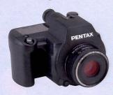
teur CCD intégré 18,6 Mpix de Kodak. Avec des dimensions de 45 x 34 mm, soit 4992 x 3744 pixels, le KAF-18000CE de Kodak vient compléter la gamme de capteurs composée de deux modèles, le KAF-16802 16 Mpix et le KAF 22000 22 Mpix. Comme Kodak vend ses capteurs à tous les fabricants photo, il faut s'attendre à retrouver prochainement le modèle CCD 18 Mpix dans d'autres produits que le Pentax 645.
