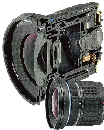
Das ZUIKO DIGITAL ED 1:4.0-5.6/9 - 18 mm im Querschnitt: die einzigartige Konstruktion der DSA-Frontlinse erlaubt eine extrem kompakte Bauweise bei hoher Bildqualität. Die volle Baulänge beträgt lediglich 73 mm.
