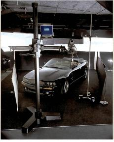
Das Säulenstativ von Foba ist motorisiert und lässt sich vom Computer aus steuern. Das neu lancierte CNS-System kombiniert wichtige Komponenten von Sinar Fachka-
