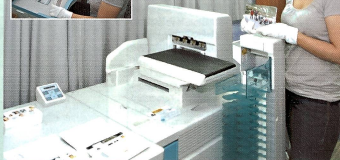
Das neue Fujifilm Frontier LP7100 ist auf eine Stundenleistung von ca. 810 Prints 10 x 15 cm ausgelegt, weist zwei integrierte Papiermagazine auf und hat einen Sorter für 12 Aufträge.
