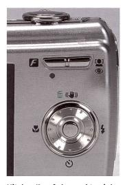
Mit dem Knopf oben rechts wird bei Fujifilm Finepix F100fd die Gesichtserkennung zugeschaltet.
