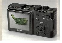
kommen. Während also 14 Megapixel bei einer normalen Kompaktkamera beim Fotokenner eher reflexartiges Kopfschütteln auslöst, ist dies bei dieser Kamera nicht angebracht. Die Sensorfläche ist sechs- bis zwölfmal grösser als in konventionellen Kompaktkameras.
