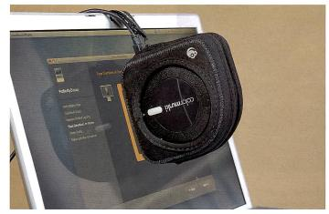
Zum Profilieren eines Monitors wird ColorMunki am Tragriemen aufgehängt; in der Hülle eingenähte Gewichte halten das Gerät in Position.
