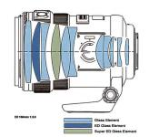
Querschnitt durch das Zuiko Digital 1:2,0/150 mm.
