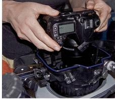
Fertigmachen zum Taucheinsatz! Die Nikon D80 wird vorsichtig in das Sea&Sea-Gehäuse eingepasst. Die Dichtungen müssen geprüft werden.
