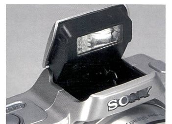
Die Sony Cybershot H3 hat einen besonders leistungsstarken Blitz für Distanzen bis zu 14 Metern.
