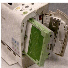
Fotopapier und Druckfolie bilden beim Canon Selphy-Drucker eine untrennbare Einheit.
