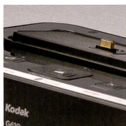
Beim Kodak-Drucker lassen sich die Easyshare-Kameras direkt auf den Drucker pflanzen.
