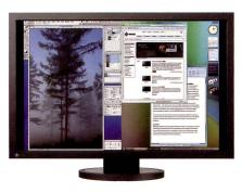
Darstellung von Auflösungen bis zu 2560 x 1600, der andere Eingang Single Link unterstützt eine Auflösung bis 1920 x 1200. Der Single Link Eingang erlaubt dank dem integrierten HDCP-Decoder, HD geschützte Inhalte wie die neuesten HD-DVDs (via PC und Mac) abzuspielen. Ein USB 2.0-Hub mit einem Upstream und zwei Downstream-Ports ist ebenfalls verfügbar.
