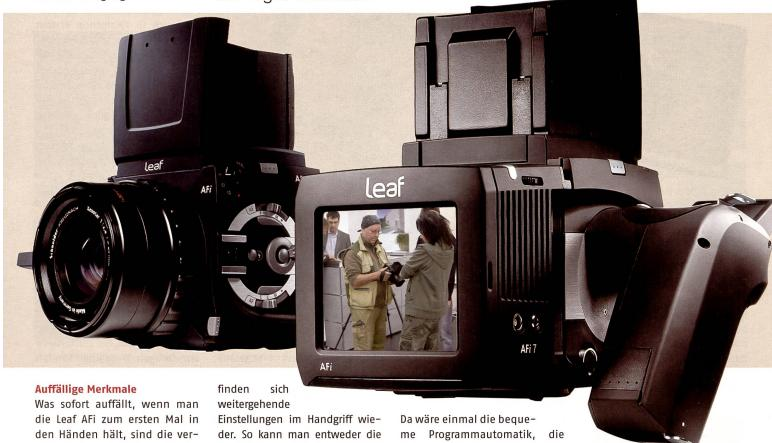
senkten Bedienelemente auf der linken Kameraseite. Dies ermöglicht es, die Kamera im sprichwörtlichen Sinn «zur Seite zu legen». Womit dies natürlich nicht gleichzusetzen ist mit «an den Nagel hängen», nein, die Leaf AFi ist so konzipiert, dass man sie zur Seite oder auf den Rücken legen kann, ohne dass die Bedienelemente oder das Display des Rückteils die Ablagefläche berühren.
