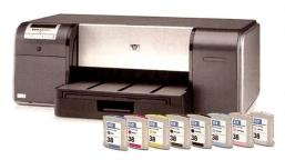
tung einer digitalen Kamera stellt. Er arbeitet mit pigmentierter Tinte in acht einzeln austauschbaren Farbpatronen (HP Vivera). Er bietet eine maximale Auflösung von 4800 x 1200 dpi und kommt mit einer Vielzahl von Spezialpapieren von 80 bis 800 g/m² bis zu einer Dicke von 1,5 mm zurecht - unter anderem auch mit den HP Druckmedien Aquarellpapier und Künstlerleinwand.
