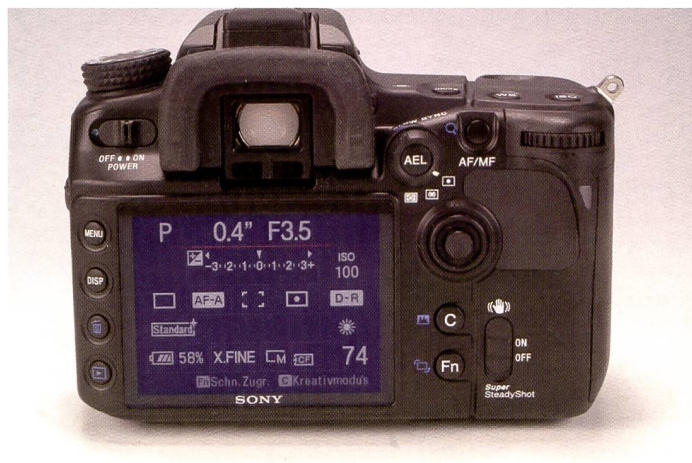
Das helle und detailreiche LC-Display der \alpha 700 mit 921'600 Bildpunkten ist ein Hochgenuss. Nie war die Bildkontrolle einfacher. Mit der Funktionstaste und dem Joystick können sämtliche Einstellungen angewählt und direkt verändert werden.
