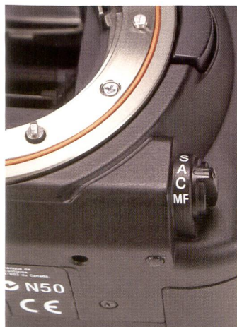
Das Kamerabajonett der Sony \alpha 700 besteht komplett aus rostfreiem Stahl. Bei den Materialien wurde auf Gewichtsreduktion gesetzt.
