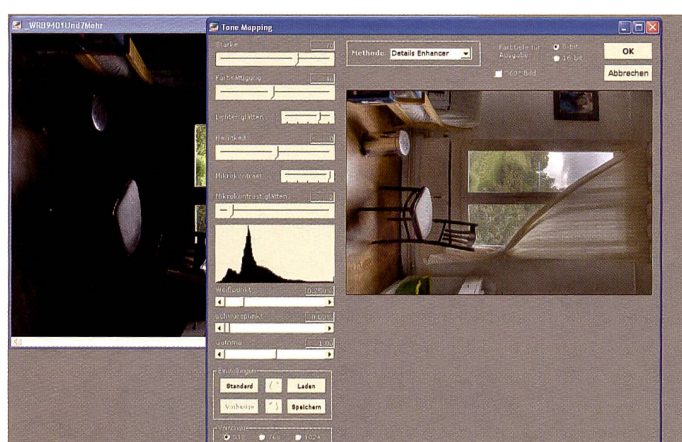
Die Benutzeroberfläche von Photomatix, nachdem das Programm die HDR-Datei erzeugt hat. Beim Umrechnen von 32 auf 8 Bit, hier als Tone Mapping bezeichnet, lässt sich noch viel beeinflussen.
