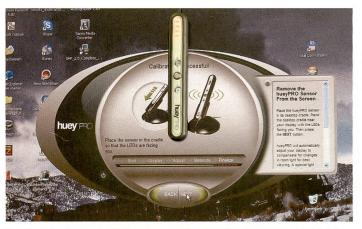
Um den Monitor zu kalibrieren, muss das Colorimeter auf dem Bildschirm plaziert werden. Dank Saugnäpfen hält er dort, vorausgesetzt, Monit5or und Saugnäpfe sind sauber. Der Mess- und Kalibriervorgang dauert lediglich einige Minuten.
