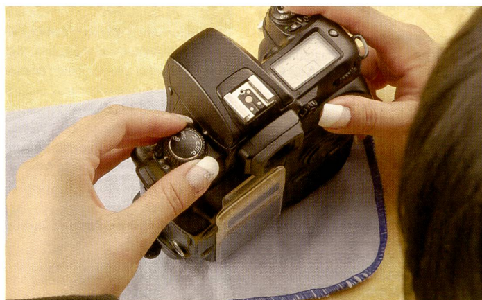
Je nach Kameramodell wird die Einstellung für die Sensorreinigung im Menü oder an Einstellelementen an der Kamera vorgenommen. Der Spiegel muss ausgelöst, der Verschluss geöffnet werden, ohne dass der Sensor aktiviert wird.
