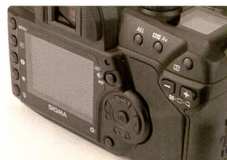
Gut gelöst sind die Schnelleinstellungen mit dem Wählkreuz rechts neben dem Display.
