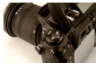
Auf dem Wählrad sitzen weitere Einstellungsknöpfe, etwa für Weissabgleich und ISO-Einstellungen.
