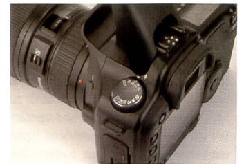
Das zweite Display auf der Oberseite der EOS erleichtert den Überblick über die Einstellungen.
