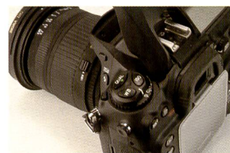
Auf dem Wählschalter sitzen weitere Einstellungsknöpfe, etwa für Weissabgleich und ISO-Einstellungen.
