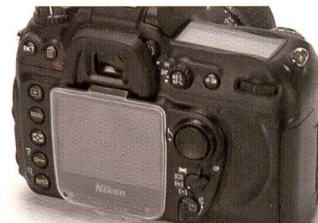
Komfortabler Mehrweg-Wippschalter rechts neben dem Display für die AF-Einstellungen.
