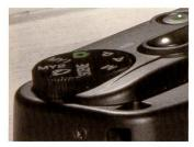
Einfache Bedienung dank zentralen Einstellelementen mit Zugriff zu Blendenvorwahl, manuelle Belichtung oder Weissabgleich.
