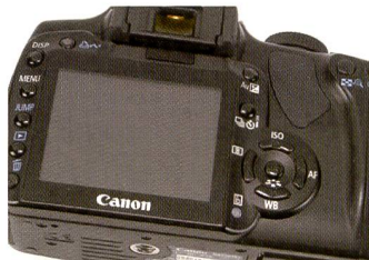
Aus Platzgründen hat die EOS 400D kein Einstellrad, sondern ringförmig angeordnete Drucktasten.
