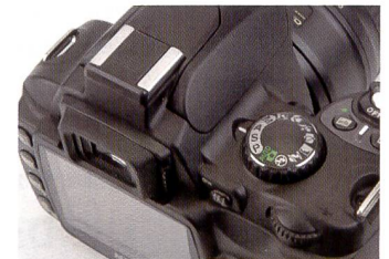
Das hintere Einstellrad regelt je nach Belichtungsmodus die Blende oder die Verschlusszeit.
