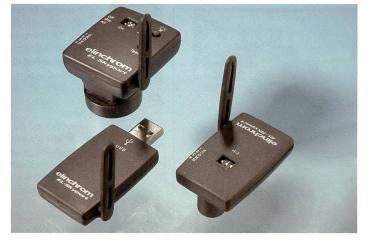
Komplett-Set EL-Skyport bestehend aus Transmitter 13351 (oben), USB RX 19354 (links) und Transceiver RX 19353. Mit einem Sender, USB RX und Transceiver (je 1 Stück pro Leuchte) kann das gesamte Fotostudio ferngesteuert werden. Einstellungen können gespeichert und bei Bedarf wieder abgerufenwerden, so dass sich jede Leuchte wieder auf den gespeicherten Wert einstellt.
