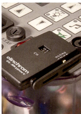
EL-Skyport Transceiver RX: Brauchen entsprechende Schnittstelle an RX-Geräten und ermöglichen Steuerung der Leuchte von Kamera oder Computer aus. Speichert Anzahl Blitze u.ä.
