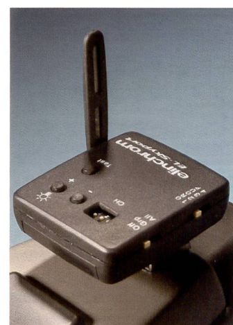
Der Transmitter wird auf dem Zubehörschuh der Kamera montiert. Mittels Tasten können Blitzleistung und Pilotlicht eingestellt und Testblitze ausgelöst werden, beispielsweise für die Blitzmessung.
