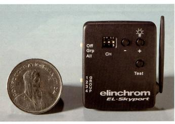
Grössenvergleich: Der Transmitter ist klein und unauffällig. Er garantiert interferenzfreies Arbeiten mit 40 Bit Verschlüsselung, bietet 8 frei wählbare Frequenzkanäle, die Arbeitsplätze separieren und Interferenzen vermeiden. Angeschlossene Geräte können in 4 Arbeitsgruppen zusammengefasst werden, wahlweise werden einzelne Gruppen oder alle (Foto: Werner Rolli) Blitzleuchten ausgelöst.
