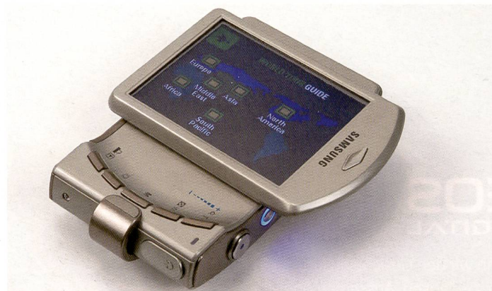
Zwei Besonderheiten der i7 auf einen Blick: Funktionsumwandlung per Displaydrehung und «World Tour Guide» mit Infos zu vielen hundert Städten.
