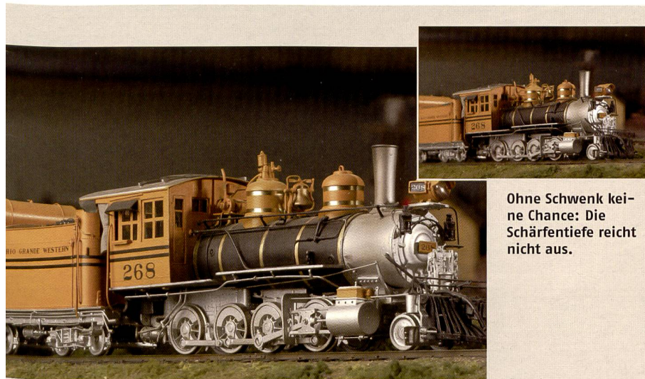
Schärfedehnung nach Scheimpflug: Verstellt man die Objektiv-ebene so, dass sich die Gegenstands-, Objektiv- und Sensorebene in einer Gerade schneiden, so wird das Motiv durch die veränderte Lage der Schärfenebene von vorne bis hinten scharf abgebildet. Foto: Werner Rolli
