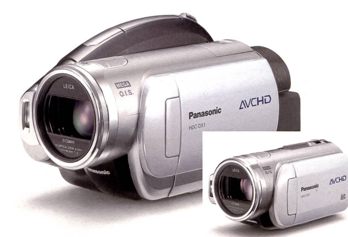
Ganz auf die neuen Speichermedien, sprich 8 cm DVD Scheiben (verschiedene Möglichkeiten) und SD-Karten setzt Panasonic mit den zwei neuen 3-CCD Camcordern im AVCHD-Aufnahmeformat. Beide verfügen über ein 10fach-Leica-Zoomobjektiv und einen optischen Bildstabilisator. Raffiniert ist das ans Zoom gekoppelte Mikrofon.
