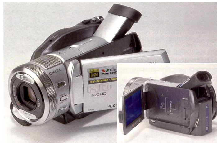
Sony gilt als Pionier der High Definition Camcorder im Amateur-Sektor. Die neuen Modelle HDR-UX1 (Bild) und die HDR-SR1 speichern in dem mit Panasonic begründeten AVCHD-Format mit MPEG4-Datenkompression. Als Speichermedien stehen je nach Modell entweder SD-Karten, Memory-Stick, Harddisk oder DVDs zur Auswahl.
