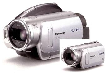
Ganz auf die neuen Speichermedien, sprich 8 cm DVD Scheiben (verschiedene Möglichkeiten) und SD-Karten setzt Panasonic mit den zwei neuen 3-CCD Camcordern im AVCHD- Aufnahmeformat. Beide verfügen über ein 10fach-Leica-Zoomobjektiv und einen optischen Bildstabilisator. Raffiniert ist das ans Zoom gekoppelte Mikrofon.
