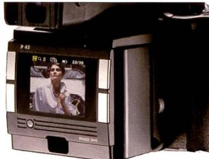
Die P+ Serie von Phase One umfasst fünf digitale Rückteile mit Auflösungen von 16, 18, 22, 31 und 39 Megapixel und wird ab Februar 2007 lieferbar sein. Bestehende Backs können aufgerüstet werden. Die wesentlichste Neuerung ist ein Live-Vorschaubild für alle Rückteile, mit dem am Monitor scharf gestellt werden kann. Letzterer ist neu 2,2 Zoll gross und hat eine Auflösung von 230'000 Pixel. Durch die Verdoppelung des internen RAM-Speichers auf 640 MB wird auch ei-
