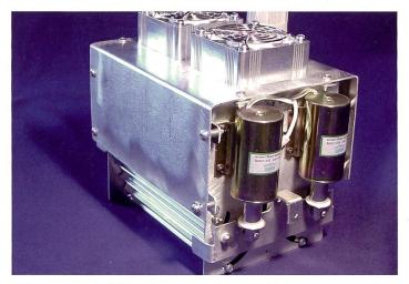
Inkjet-Druckkopf mit integrierter UV-Aushärtung. Während früher vor allem Etiketten monochrom im UV-Inkjet-Druck individualisiert wurden, sind heute Vollfarbenanwendungen mit hoher optischer Auflösung möglich.
