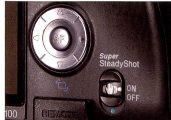
Mit dem Schalter unten rechts wird der Super Steady Shot aktiviert. Der Sensor ist schwebend befestigt, dadurch kann die Bildstabilisation mit allen Objektiven verwendet werden.
