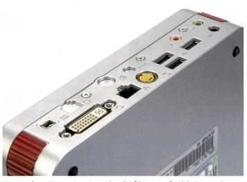
Alle Schnittstellen vorhanden: Firewire (links oben), digitaler Monitor-Ausgang (links unten), Ethernet, S-Video, USB 2.0, Audio. Ein DVD-Laufwerk ist ebenfalls integriert.
