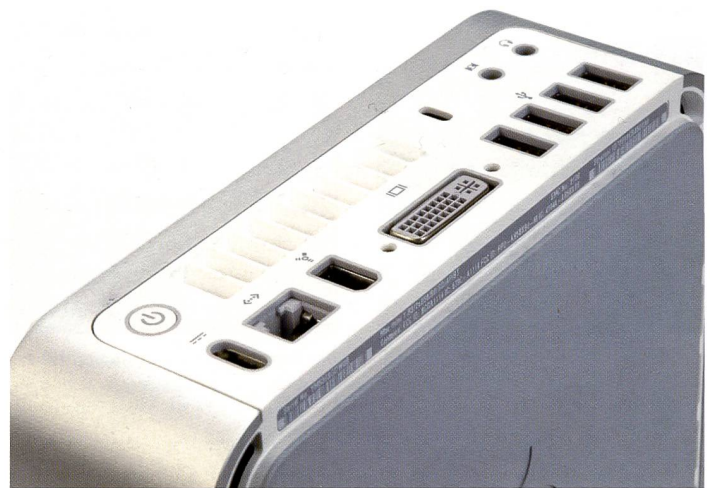
Mac-typische Schnittstellen-Ausstattung (v.l.n.r.): Power, Ethernet, Firewire digitaler Monitorausgang, USB 2.0, Mikrofon, Kopfhörer/ Lautsprecher. S-Video fehlt, DD-Laufwerk ist integriert.
