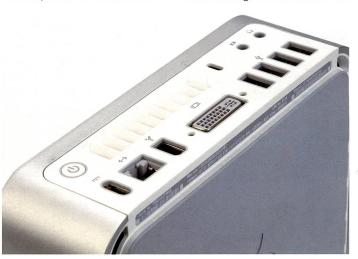
Mac-typische Schnittstellen-Ausstattung (v.l.n.r.): Power, Ethernet, Firewire digitaler Monitorausgang, USB 2.0, Mikrofon, Kopfhörer/ Lautsprecher. S-Video fehlt, DD-Laufwerk ist integriert.
