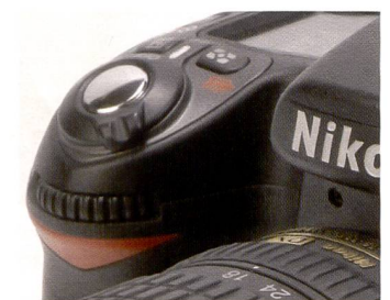
Der integrierte Blitz der Nikon D80 kann auch als Mastereinheit zur drahtlosen Steuerung von externen Blitzgeräten dienen.
