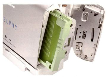
Praktisch: Die komplette Kartusche mit Folien und Papier wird gewechselt, auch wenn sie erst teilweise aufgebraucht ist. So kann man zwischen Schwarzweiss- und Farbdruck sowie mit den Formaten variieren.
