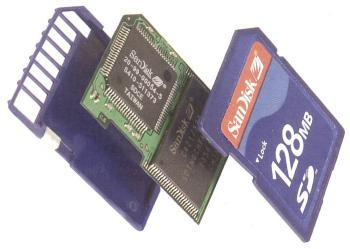
Das Innenleben einer SD Karte besteht aus zwei Einheiten: Speicherchip und Controller, wobei letzterer für Geschwindigkeit und Datensicherheit besonders wichtig ist.
