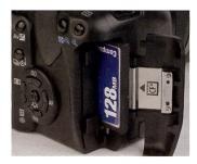
Die CF-Speicherkarte ist geschützt durch eine Klappe, die sich zuerst entriegelt, dann erst geöffnet wird.
