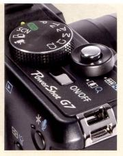
Die Art und die Anordnung der Bedienungselemente zeigt sich klassisch und sehr funktionell. Am ISO-Wahlrad kann die Systemempfindlichkeit schnell und unübersehbar für jede Aufnahme eingestellt werden. Das 2,5-Zoll grosse Farbdisplay weist einen grossen Betrachtungswinkel auf und ist tageslichttauglich. Schade, dass es nicht dreh- und schwenkbar ist.
