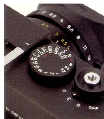
Der schnelle Verschluss erlaubt mit Blitz Belichtungszeiten bis zu 1/250 Sekunden. Ein klassischer Drahtauslöser kann verwendet werden.
