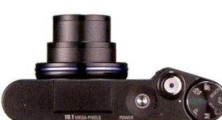
Edel und luxuriös präsentiert sich die neue Samsung NV10, deren lichtstarkes Objektiv sich bei Nichtgebrauch völlig ins Gehäuse einzieht. Sie ist mit einem 10 Mpix-Sensor ausgestattet und wird über die berührungsempfindlichen Touch & Click-Elemente neben dem Monitor bedient.
