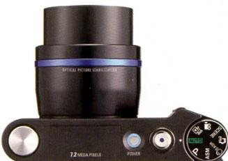
Die neue Samsung NV7 OPS nutzt Spiegelreflex-Technik, um in der Sensorebene die Entfernung zu messen. Auch die Bildstabilisierung erfolgt mechanisch durch Bewegung des Sensors. Das lichtstarke 7fach-Zoom wird durch ein 5faches Digitalzoom erweitert. Supermakromodus bis 1 cm.
