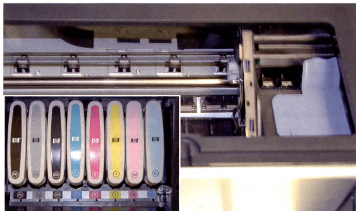
Vier Druckköpfe mit 8448 Düsen bringen die acht verschiedenen Farben zu Papier.
